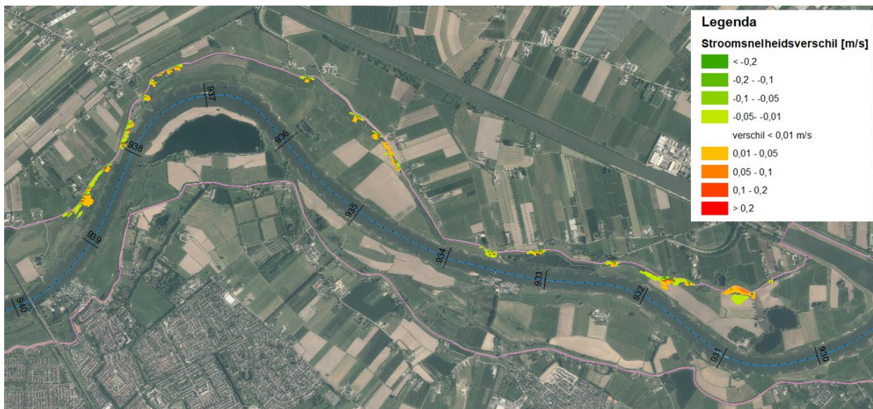
Figuur 6: Stroomsnelheidsverschil t.o.v. de referentie (2D) bij een afvoer van 16.000 m 3 /s te Lobith (variant – referentie).
